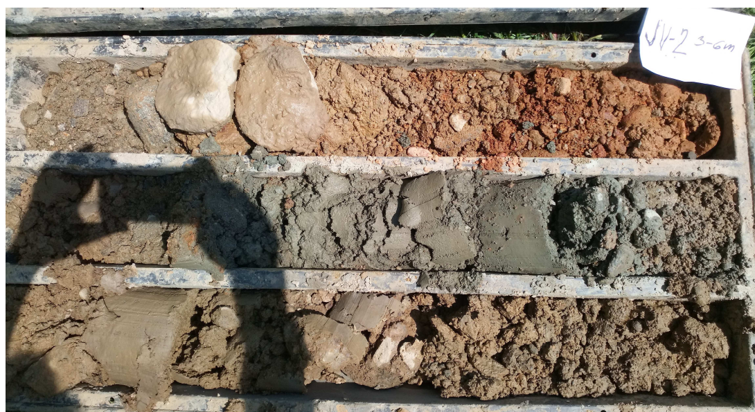
Foto 5: Fotodokumentace vrtu JV-2 (3,0m vlevo nahoře; 6,0m vpravo dole)
