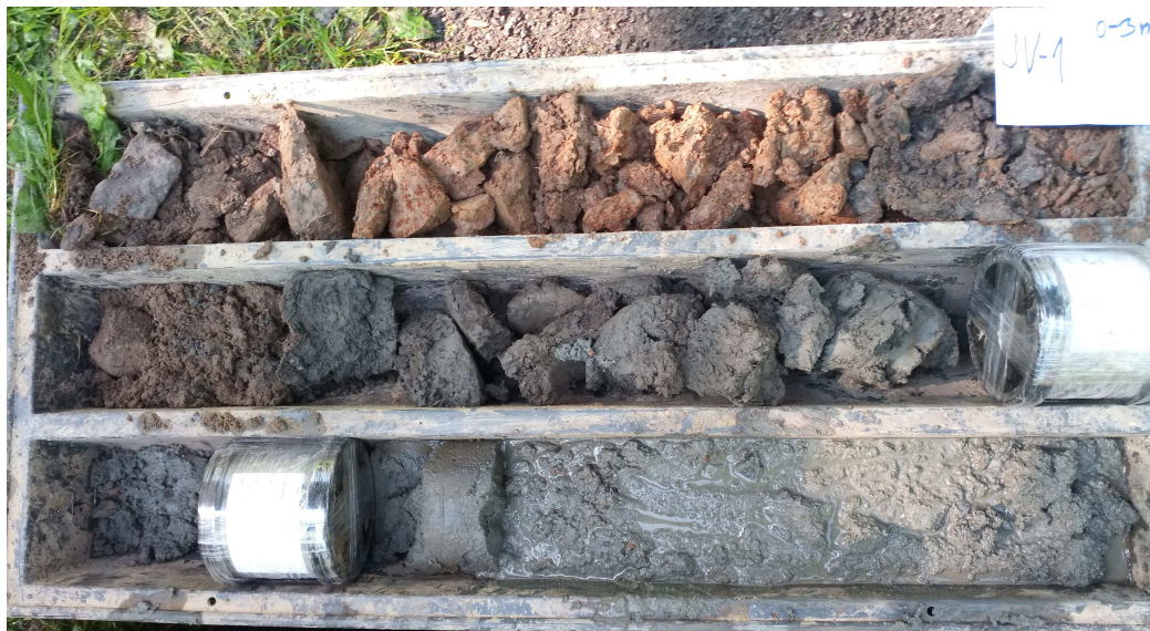
Foto 1: Foto dokumentace vrtu JV-1 (0,0m vlevo nahoře; 3,0m vpravo dole)
