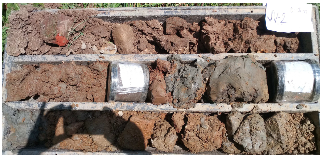
Foto 4: Fotodokumentace vrtu JV-2 (0,0m vlevo nahoře; 3,0m vpravo dole)
