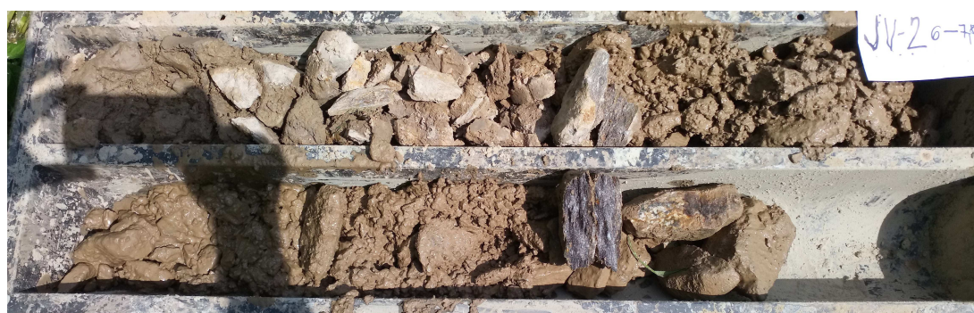
Foto 6: Fotodokumentace vrtu JV-2 (6,0m vlevo nahoře; 7,8m vpravo dole)
