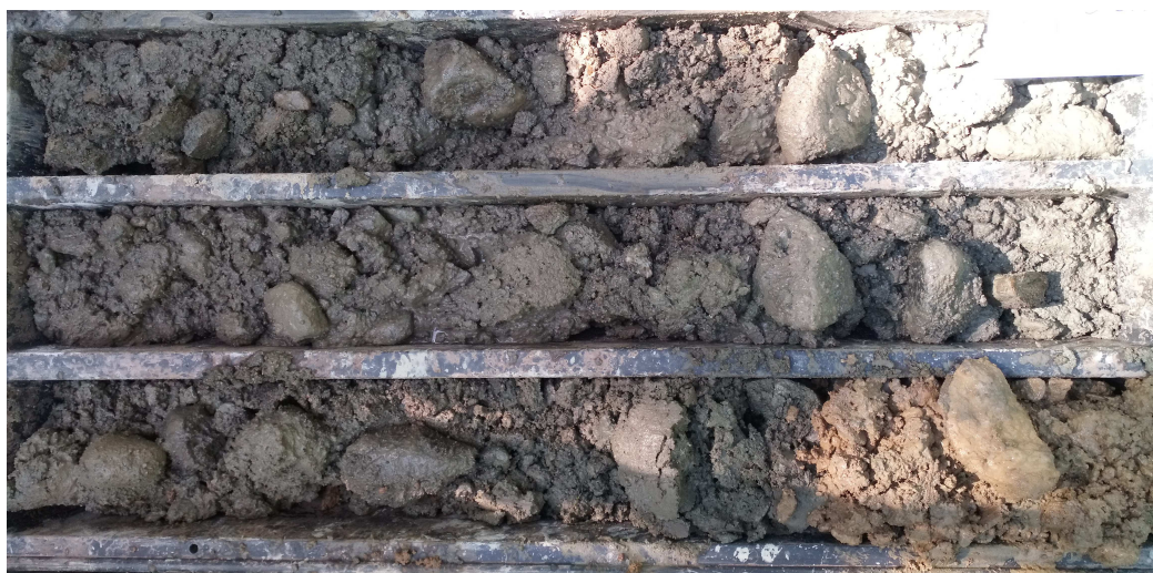
Foto 2: Fotodokumentace vrtu JV-1 (3,0m vlevo nahoře; 6,0m vpravo dole)
